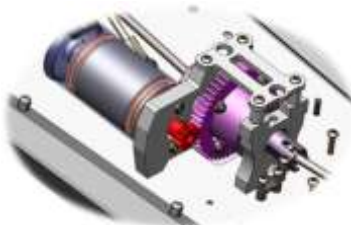
Engrenage moteur/différentiel voiture RC
